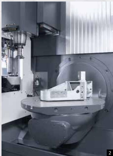
1: Lavorazione flessibile da 3 a 5 assi 2: Ottima visibilità della zona lavoro con magazzino utensili opzionale 3: Tavola simultanea
