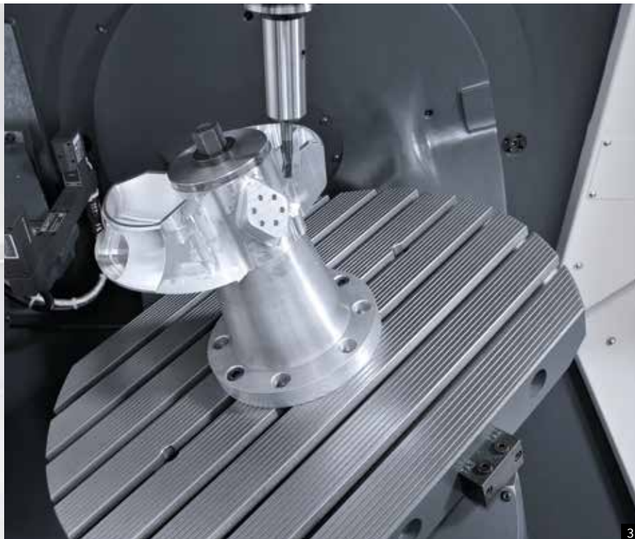
1: Lavorazione flessibile da 3 a 5 assi 2: Ottima visibilità della zona lavoro con magazzino utensili opzionale 3: Tavola simultanea
