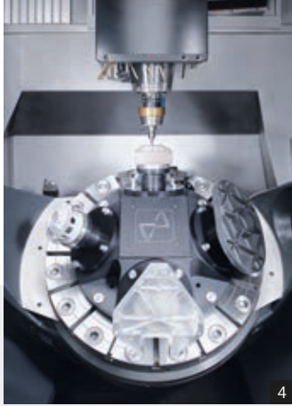
4: Flexible ULTRASONIC-Technologieintegration via HSK-A63- / HSK-A100-Schnittstelle 5: Dünnwandige Leichtgewichtsstrukturen in optische Komponenten z. B. aus Zerodur 6: Kamergehäuse für Luftraumüberwachung aus Siliziumnitrid
