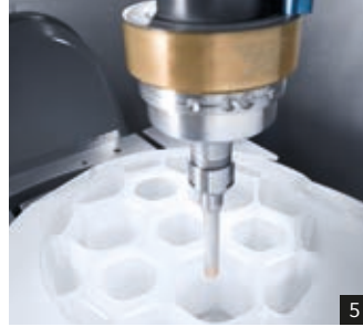
4: Flexible ULTRASONIC-Technologieintegration via HSK-A63- / HSK-A100-Schnittstelle 5: Dünnwandige Leichtgewichtsstrukturen in optische Komponenten z. B. aus Zerodur 6: Kamergehäuse für Luftraumüberwachung aus Siliziumnitrid
