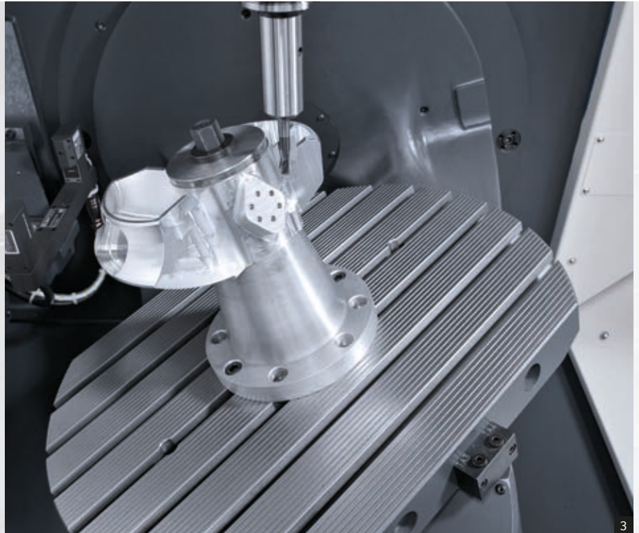
1: Flexible Bearbeitung von drei bis fünf Achsen 2: Gut einsehbarer Arbeitsraum mit optionalem Werkzeugmagazin 3: Simultantisch
