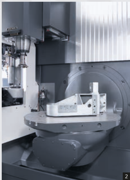
1: Flexible Bearbeitung von drei bis fünf Achsen 2: Gut einsehbarer Arbeitsraum mit optionalem Werkzeugmagazin 3: Simultantisch
